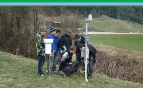
Bild 1: Eine von zehn Wetterstationen für die Messung von photosynthetisch aktiver Strahlung (PAR), Niederschlag, Lufttemperatur und -feuchte, sowie Bodentemperatur und -feuchte (Kramtschach); junge Landwirte beim Kennenlernen der Funktion einer Wetterstation.
