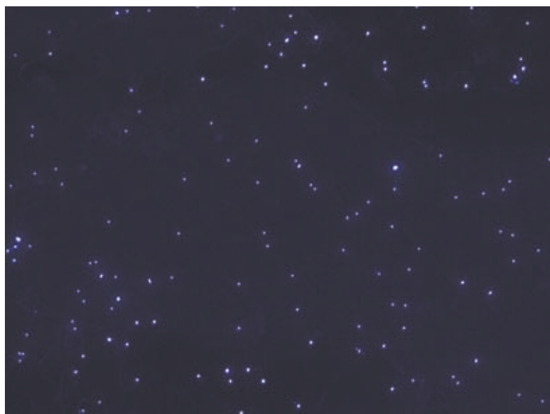
Die Mikrospherule (Latexkügelchen) unter dem Epifluoreszenzmikroskop. Die Verunreinigungen leuchten farbig auf. Foto: ÖWF/Gernot Grömer
