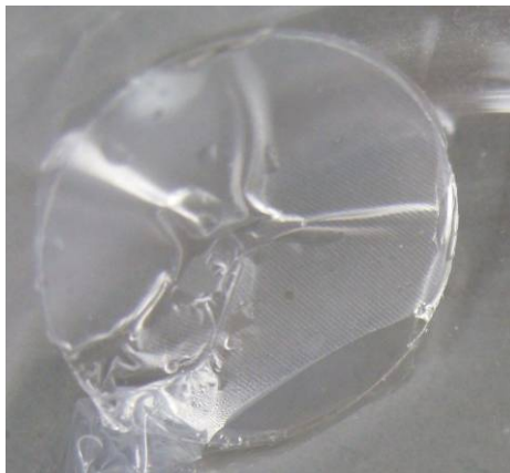
Abbildung 5.14: Ablösende Polymerschicht am Cover Slip
