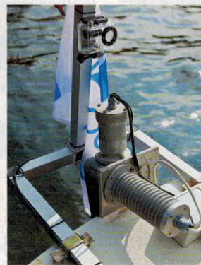
RUDERGÄNGER Ein Getriebemotor bewegt das Ruder. Es braucht kaum Kraft, da es vorbalanciert ist
