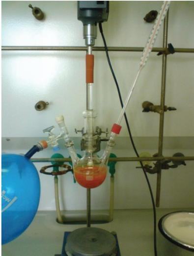
Abbildung 22: Aufbau der Apparatur für die Wittig-Reaktion
