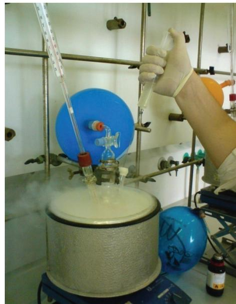
Abbildung 19: Versuchsaufbau für Lithiierung
