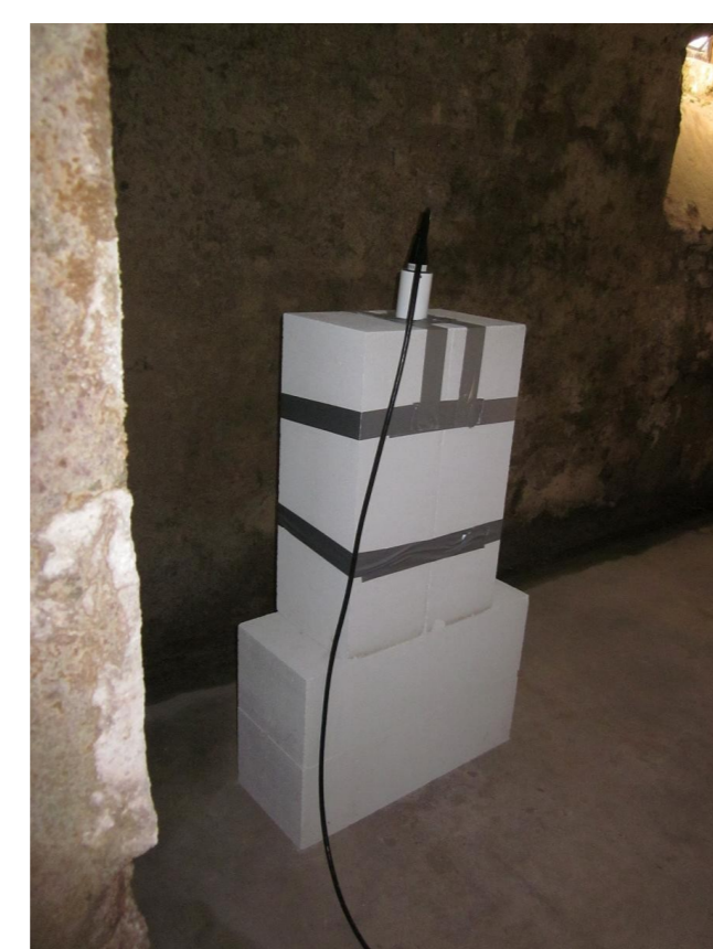
Abb. 4: Ein Caesium-Magnetometer in Graz. Die Standorte für die Stationen wurden alle von Schülern vorgeschlagen und bewertet. Diese Station ist in einem Privatkeller untergebracht. Die Station in Tamsweg wurde in einer Schule und jene in Innsbruck in einem Stollen am Stadtrand aufgebaut.
