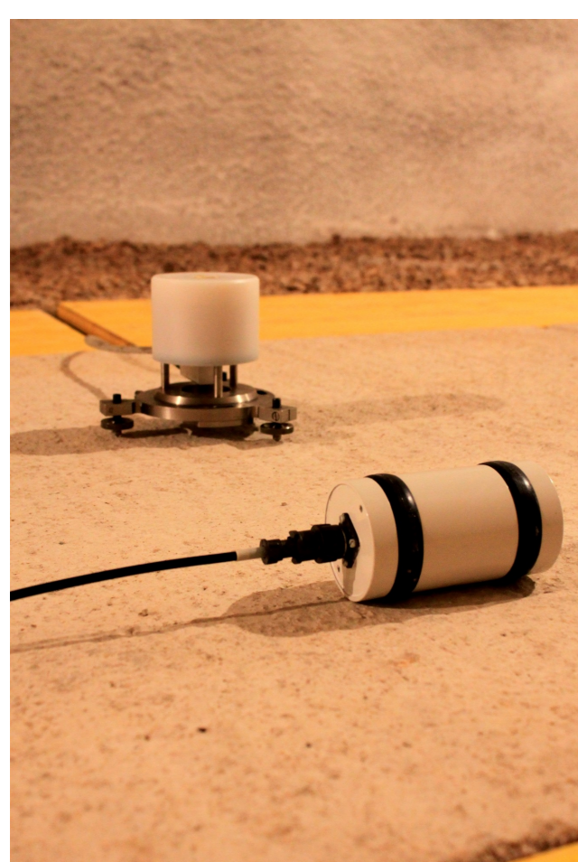
Abb. 2: Zwei der geomagnetischen Stationen bestehen aus einem skalaren Magnetometer (vorne) für Messungen der gesamten Feldstärke und einem Variometer (hinten), das die Feldrichtung der einzelnen Komponenten aufzeichnet.
